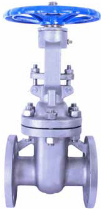
Fig. GA AI 150 BL - Válvula compuerta, acero inoxidable T316. ANSI WCB A216 clase 150
